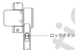
ジンバル機構の電源が切れたり、手ブレ防止機能をオフにしている時は、スマホの向きを調整した後、ロックすることで自撮り棒モードとして使えます。ロックボタンを上スライドさせてロックし、伸縮ロッドを適度に伸ばして下さい。
