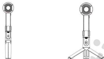
片手で自撮り棒の上端を持ち、もう一方の手で自撮り棒の下部にある溝からゆっくりと三脚部分を展開してください。
