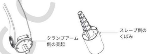
**メモ:** 手ブレ防止機能を効果的に使うために、クランプアームの向きと伸縮ロッド、スレップの位置が揃うようにして下さい。ジンバル機能による安定した撮影になります。
